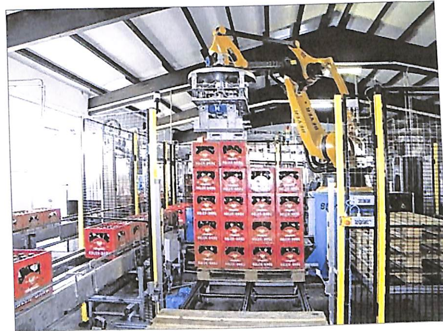
500 Kästen in 60 Minuten stapelt der unlängst in Betrieb genommene Roboter der Stettfelder Adler-Bräu auf Paletten, um sie transportfertig zu machen. Foto: Ziegler
